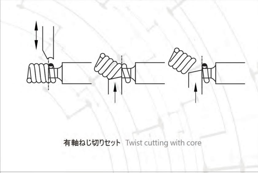
有軸ねじ切りセット Twist cutting with core
