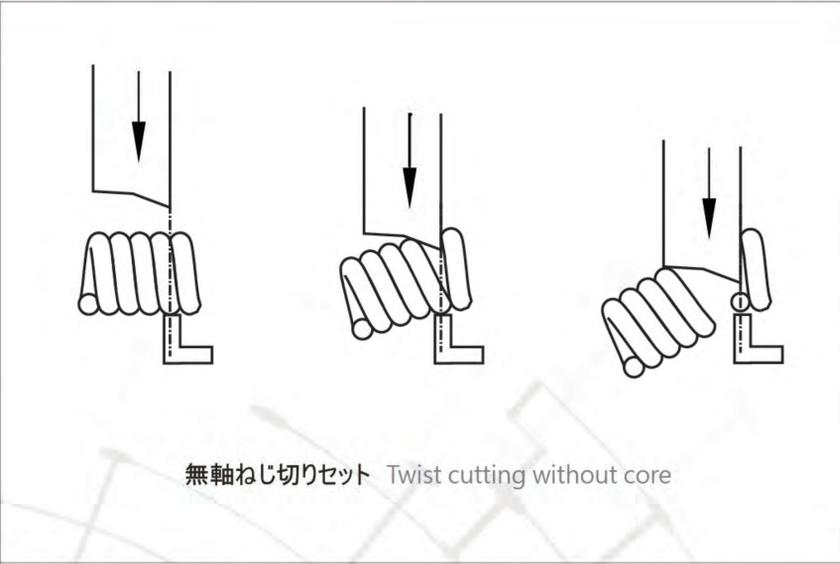
無軸ねじ切りセット Twist cutting without core
