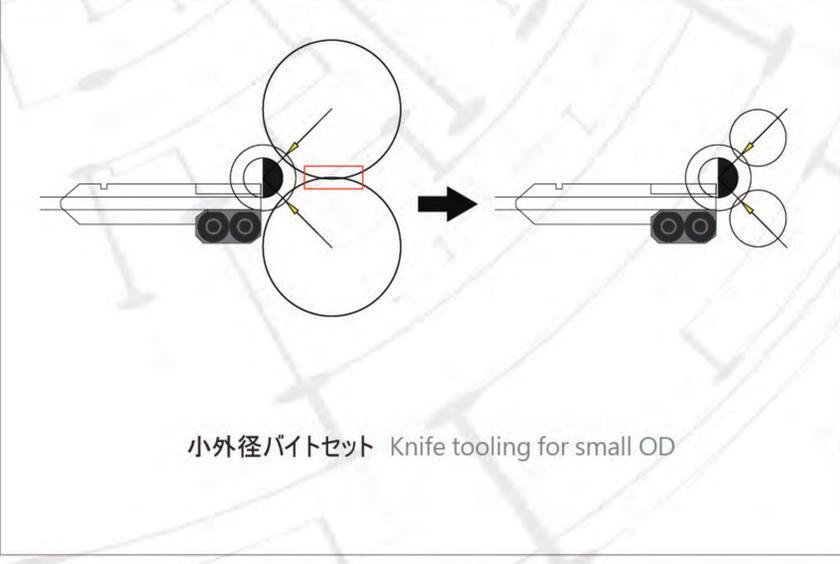
小外径バイトセット Knife tooling for small OD
